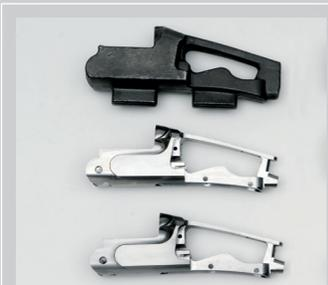
Una caratteristica saliente che contraddistingue la produzione Fossari® è rappresentata dalla bascula monolitica realizzata interamente partendo da un pezzo unico d'acciaio lavorato su CNC a 5 assi. Le chiusure tipo Boss, hanno il chiavistello di chiusura sovradimensionato e posto sulla mezzeria della canna, che garantisce una tenuta illimitata nel tempo. Per una maggior resistenza ed affidabilità tutti i componenti essenziali del fucile sono ricavati da masselli forgiati.
