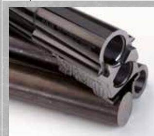
Canne in acciaio speciale trilegato, ricavate da foratura barra. Anima e camere cromate internamente, per assicurare maggiore durata e resistenza alla corrosione e rosate meglio distribuite. Special three-alloyed steel barrel machined out of bored bars. Internally-chromed bore and chambers for improved lifespan and corrosion resistance and better-distributed shot patterns. Canons en acier spécial à triple alliage, usinés à partir du percement de la barre. Ame et chambres chromées intérieurement pour garantir une meilleure durée et résistance à la corrosion et une meilleure régularité de gerbe.
